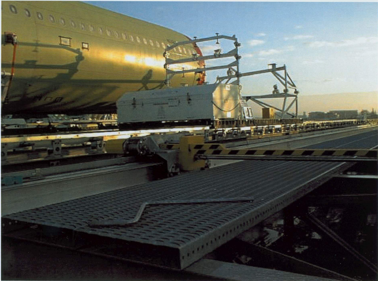
Handling- und Kommissioniersystem für Flugzeugkomponenten Handling and storage systems for aircraft sections.
